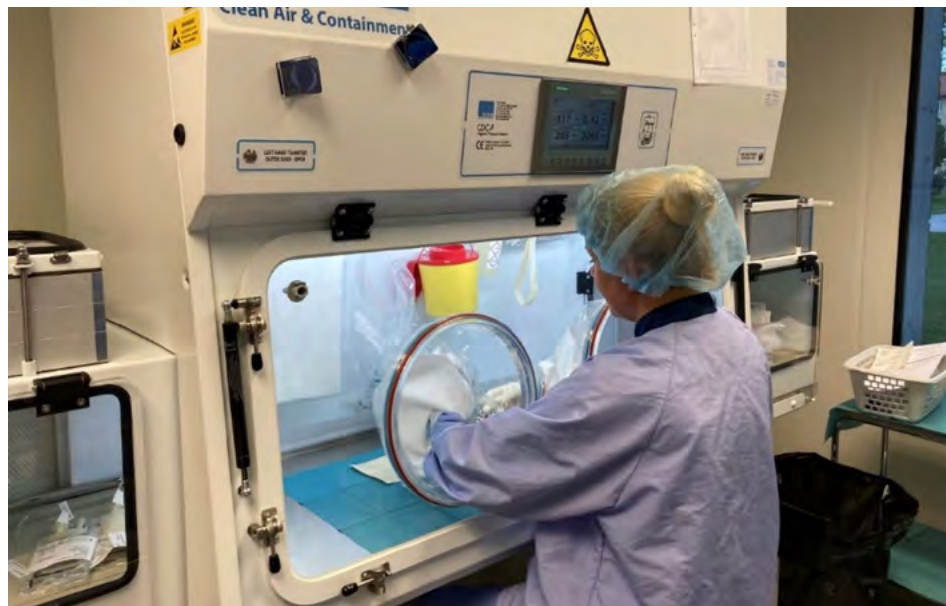
Tillverkning av cytotstatika i isolator.
